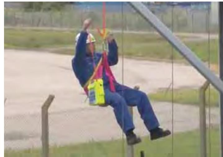
إن جهاز الهبوط ذاتي التحكم من دونت آند دونت سيفلاند هو نظام السلامة الذي يستخدمه المتقون في نهاية المطاف فهو مثالي للهروب من توربينات الرياح البرية والبحرية.
